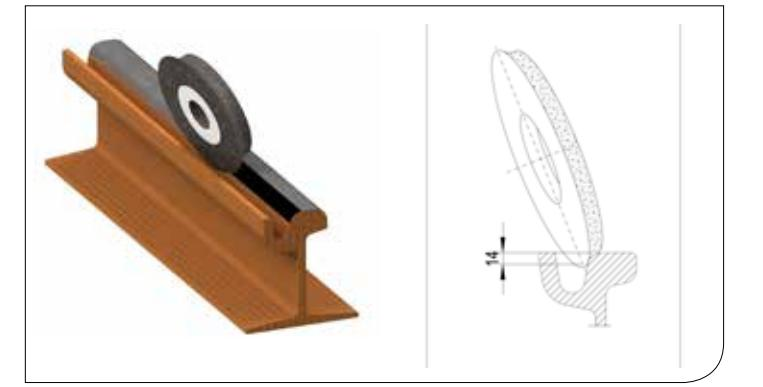
Gracias a esta configuración particular, las muelas mantienen constante el perfil de desgaste, independientemente del perfil desgastado del carril y la superficie a mecanizar es rectificada diagonalmente respecto a la dirección longitudinal del carril. En sustancia, el consumo del material muela/carril regenera continuamente el radio del perfil de la muela para el cual se ha predisputo el módulo de amolado.
