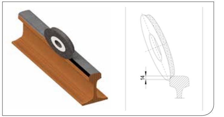
Grâce à cette configuration particulière, les meules maintiennent leur profil d'usure constant indépendamment du profil usé du rail et la surface à usiner est meulée diagonalement par rapport à la direction longitudinale du rail. Dans la pratique, la consommation du matériau meule/rail régénère continuellement le rayon du profil de la meule pour lequel le module de meulage a été prévu et paramétré.
