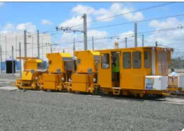
L'image ci-dessous illustre un exemple de configuration de l'unité de meulage et de la modalité de travail des modules individuels pour rétablir le profil transversal et longitudinal du rail.
